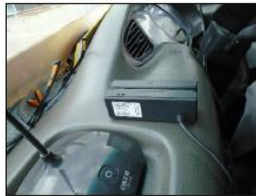
GPS ที่ติดตั้งอยู่ในตัวรถ ข้อมูลจะ ไปปรากฏที่บริษัทผู้ขนส่ง (จะ อ่านค่าแบบ Real Time)
